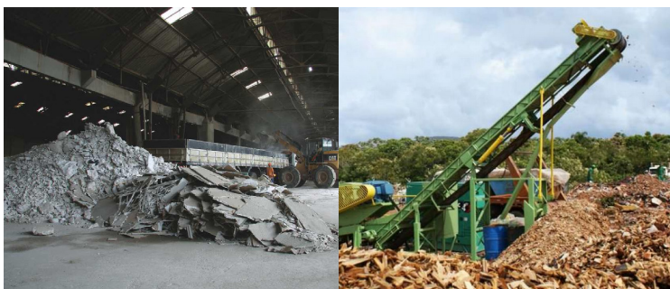
Figura 7 - ATT específica para recebimento e triagem de resíduos de gesso (foto acima). Geralmente o resíduo é usado como gesso agrícola, usado como adição para produção de cimento, etc. Unidade que recebe e processa madeira serrada como cavacos, briquetes, geralmente reciclado como biomassa. Fontes: http://www.brechoarte.com.br ; http://www.lippel.com.br .
