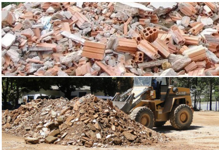
Figura 14 - Diferença entre resíduos de alvenaria contendo cerâmica vermelha (acima) do resíduo misto contaminado com solo (abaixo). Fonte das imagens: https://www.reciclateca.org.br/material-reciclavel/outras-pneu-e-entulho/attachment/lixo-entulhos-construcao/ / https://prefeitura.pbh.gov.br/noticias/bh-em-pauta-entulho-de-construcao-civil-e-reaproveitavel
