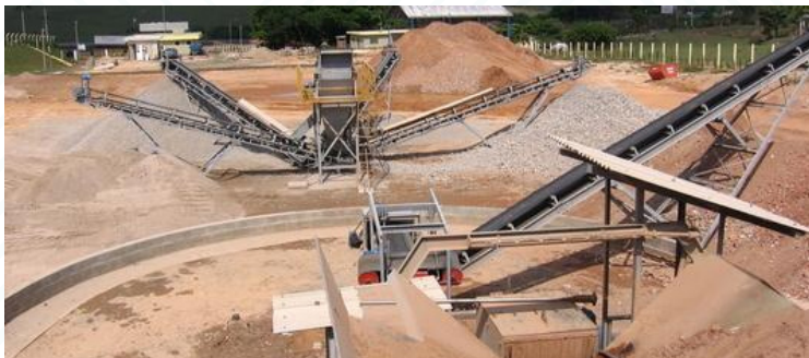
Figura 11 - Usina fixa com configuração bem simplificada (grelha, britador, combinado ou não com peneira). Pode-se obter tipos diferentes de agregados reciclados; bica corrida mista (para pavimentação) ou agregado cimentício classificado (pedrisco, rachão), solo escalpado (não classificado por tamanho). Fonte da imagem: https://www.sustentaresaneamento.com.br/reciclagem-de-entulhos/
