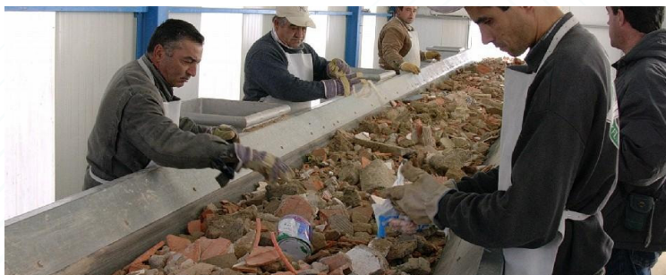
Figura 20 - Exemplos de cabines (e/ou mesas) de triagem em usinas de reciclagem com pessoal sem todos os EPI recomendados. A vazão de material na alimentação da esteira parece excessivo e fora das condições ideais (mais eficiente) de operação. Foto: S. C. Angulo
