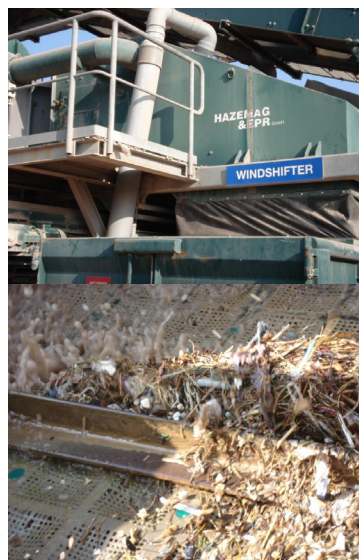
Figura 27 - Materiais leves removidos pela força do ar, em aeroclassificadores (classificadores pneumáticos gravitacionais). Fontes: Sérgio C. Angulo [33], Hendriks et. al. adaptado [37].
