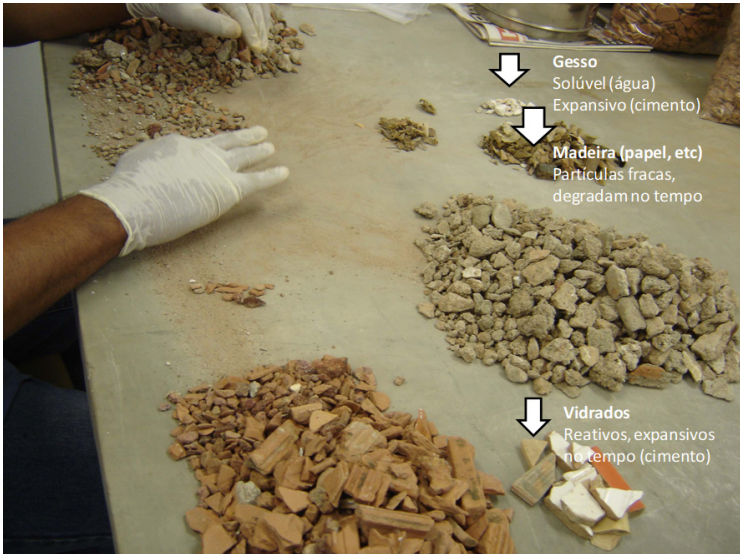
Figura 44 - Classificação dos materiais presentes nos agregados reciclados pelo ensaio de catação. O método só é aplicado na fração grádua (acima de 4,8 mm).
