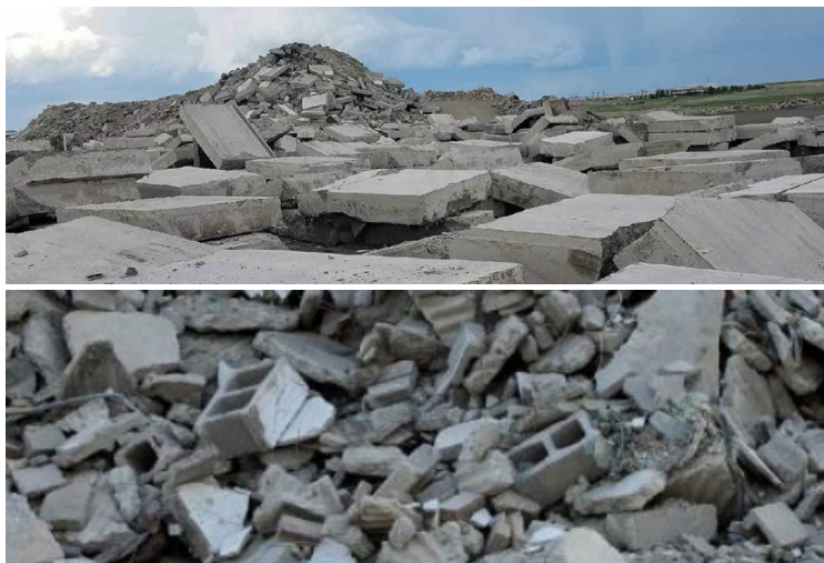
Figura 13 - Diferença entre resíduos de concreto estrutural (à esquerda) do resíduo cimentício (que contém blocos de vedação - alvenaria cimentícia, argamassas, etc) (à esquerda). Imagens obtidas através da Google Images.
