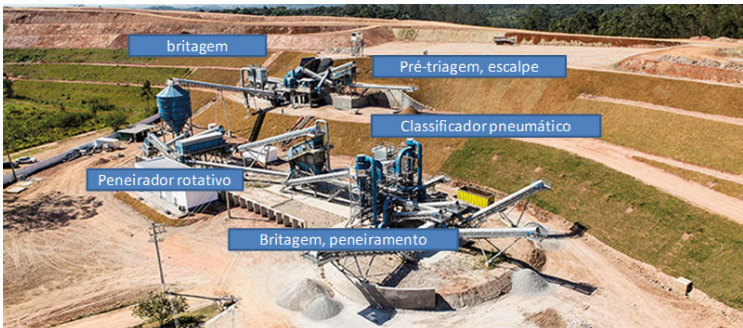
Figura 39 - Ilustração de uma das maiores usinas de reciclagem que operaram na América Latina. Foi propriedade da empresa Odebrecht Ambiental e operou na cidade de São Paulo.
