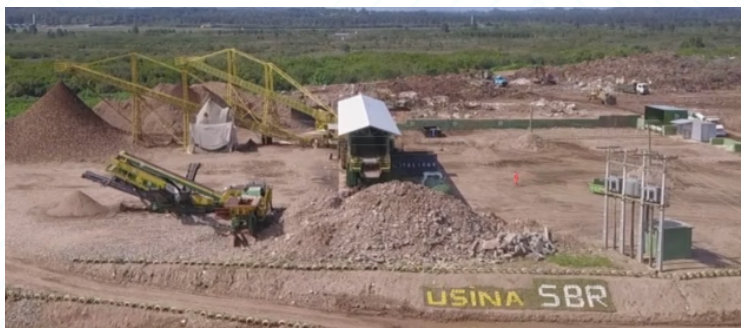
Figura 8 - Usina de Reciclagem de resíduo de construção Classe A, que produz agregados reciclados para aplicação em obras de pavimentação ou produção de materiais cimentícios. SBR Ambiental. Fonte: https://sbrreciclagem.com.br/ .
