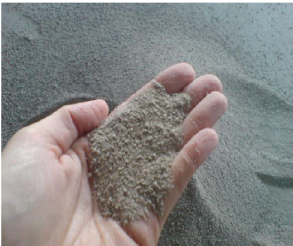
Figura 50 - Areia reciclada cimentícia usada para produzir argamassa de assentamento e revestimento em obra.
