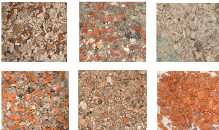
Figura 30 – Resultado da separação dos agregados graúdos mistos por equipamento de separação óptica. É possível separar com eficiência elevada (mais de 90% da massa) a cerâmica vermelha. Fonte: Sérgio C. Ângulo [44]
