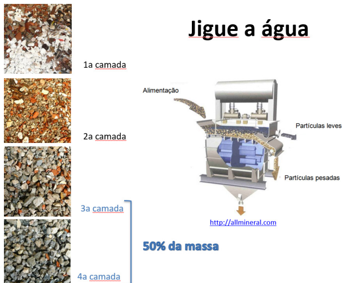
Figura 28 - Ilustração do jigue à água e o processo de separação por estratificação, que classifica o agregado reciclado em camadas, com composições diferentes. Nas camadas de cima, estão os materiais mais leves (gesso, madeira, asfalto), cerâmica vermelha, depois a fração mais densa, composta por agregado natural e pasta de cimento endurecida do concreto ( d-2,3-2,4 \text{ g/cm}^3 ). Fonte: notas de aula Sérgio C. Angulo [41], Khoury et al. [40] catálogo de equipamento da empresa All Mineral, da Alemanha.
