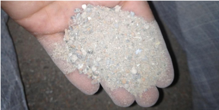
Figura 55 - Pedrisco (6,3-0mm) reciclado cimentício, usado na confecção de componentes pré-fabricados de concreto (como blocos de vedação e pavers - blocos de pavimentos intertravados).
