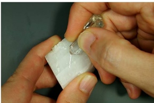
Figura 3.8. O quartzo (dureza 7) risca a calcita (dureza 3) com facilidade. Foto: Lauro K. Dehira.
