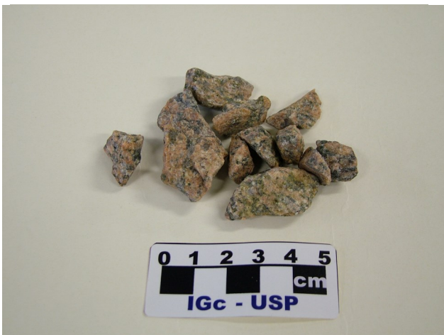
Figura 14.14. Exemplo de brita n° 1, produto de rocha granítica. Foto: Eliane A. Del Lama.
