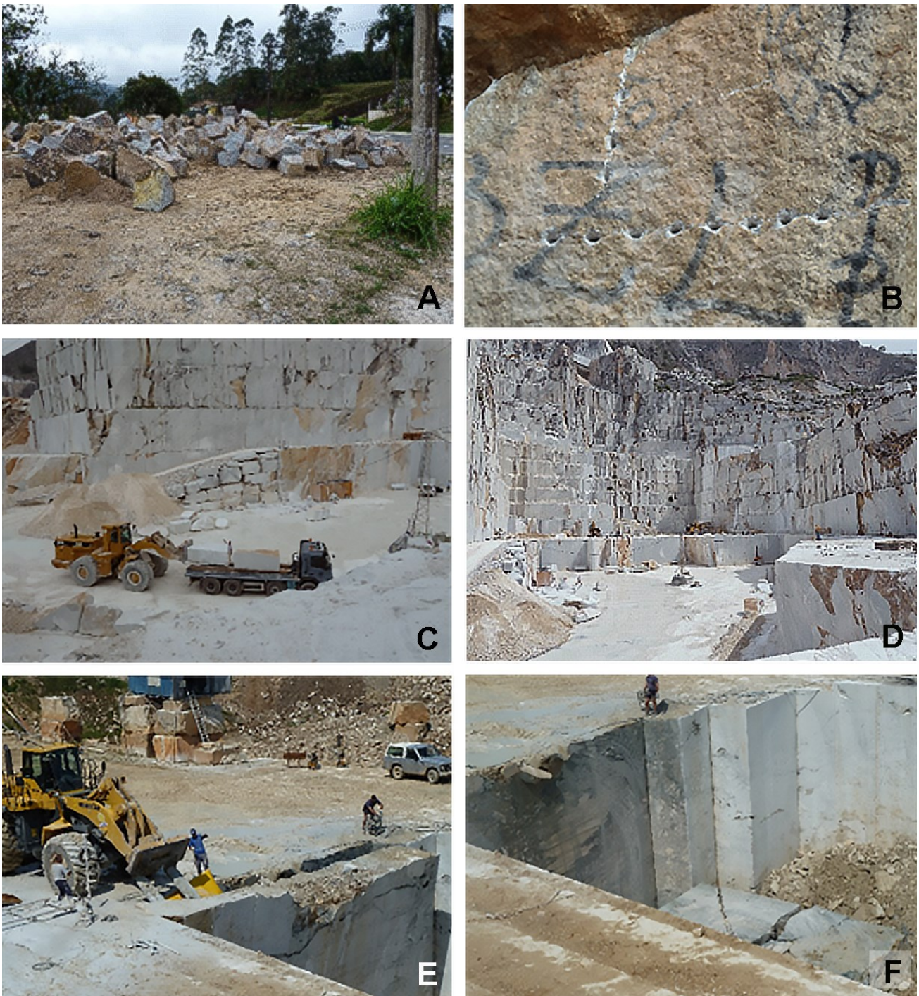
Figura 13.3. A. Blocos preparados para transporte com tamanhos adequados para corte de rochas ornamentais, pedreira na região de Ribeirão Pires, SP. Este granito fornece a matéria-prima para o chamado Granito Cinza Mauá . B. Detalhe dos furos alinhados feitos por talhadeira utilizados para a quebra do bloco, pedreira na região de Ribeirão Pires, SP. C. Vista parcial de pedreira de mármore da região de Carrara, Itália, com bloco sendo carregado para transporte. D. Vista de frente de lavra com cortes já preparados para obtenção de blocos, mesma pedreira de C. Este mármore é o mesmo tipo usado por Michelângelo para esculpir a estátua Davi. E. Máquina desmontando bloco em uma frente de lavra em pedreira de travertino (calcário estratificado depositados por fontes de águas termais), Tívoli, Itália. F. Frente de lavra da mesma pedreira da foto E. Fotos: Eliane A. Del Lama.
