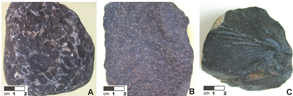
Figura 5.12. Rochas máficas constituídas de plagioclásio e piroxênio, cristalizadas em diferentes profundidades, resultando em diferentes texturas (A: gabro, textura fanerítica; B: diabásio, textura de rocha subvulcânica; C: basalto, textura afanítica). Fotos: Lauro K. Dehira, coleção didática do IGC-USP.
