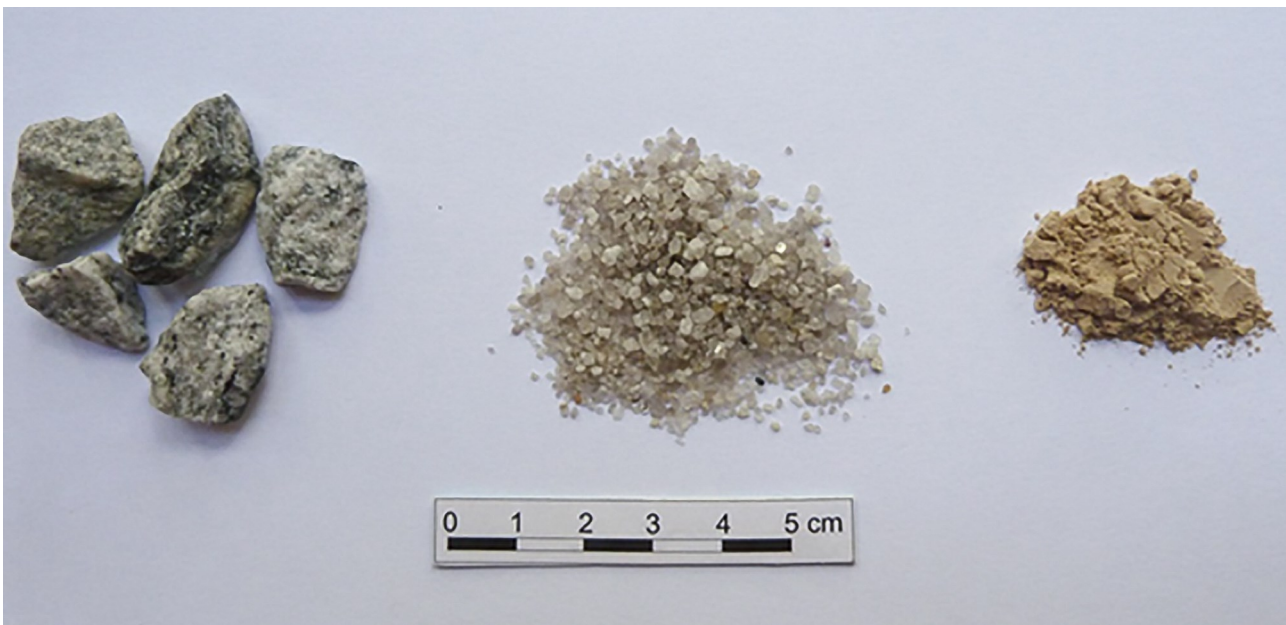
Figura 6.8. Da esquerda para a direita: cascalho (fragmentos centimétricos de granito), areia média a grossa (predomínio de grãos de quartzo) e silte (mistura de argilominerais com grãos finos de quartzo). Foto: Lauro K. Dehira.
