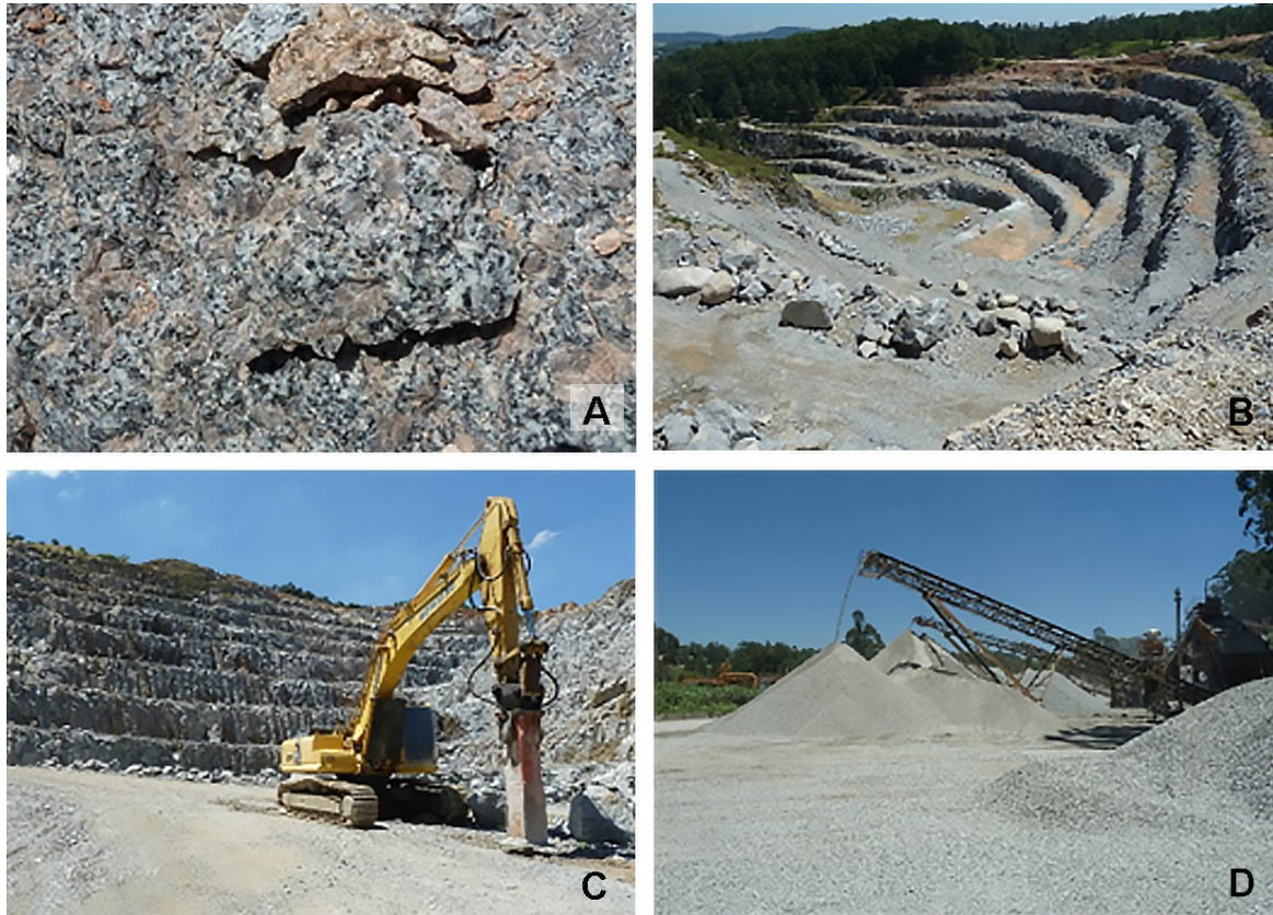
Figura 13.2. A. Aspecto do Granito Taipas, uma rocha granítica com feldspatos de dimensões centimétricas, em exploração para brita na Pedreira Construcap (n. 7 da Figura 13.1). B. Visão geral da pedreira em início de 2013. C. Visão da pedreira com máquina perfuratriz. D. Sistema de correias para distribuição dos fragmentos peneirados, após britagem, sendo colocados nas respectivas pilhas granulométricas. Fotos: Eliane A. Del Lama.
