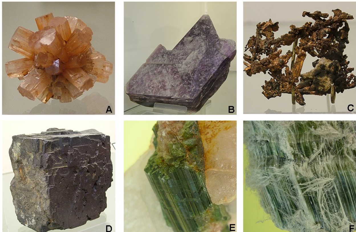
Figura 3.3. Exemplos de hábito: agregado colunar na aragonita (A), lamelar na lepidolita (B), dendrítico no cobre nativo (C), cúbico na galena (D), prismático na turmalina (E) e fibroso na serpentina (F). Fotos: Lauro K. Dehira.
