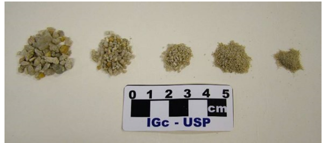
Figura 14.15. Exemplos de agregado miúdo, exemplificado com várias classes granulométricas de areia: 4,8-2,4 mm; 2,4-1,2 mm; 1,2-0,6 mm; 0,6-0,3 mm e 0,3-0,15 mm. Foto: Eliane A. Del Lama.
