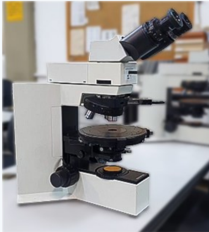
Figura 10.8. Microscópio petrográfico é basicamente diferente do microscópio biológico por poder usar, para iluminação dos objetos, a luz polarizada.
