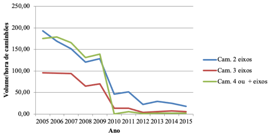
Figura 6 - Valor médio do volume/hora de caminhões, na Av. dos Bandeirantes sentido Marginal Pinheiros – Rod. Anchieta, segundo número de eixos, período 2005-2015
