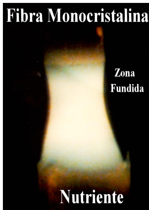
Figura 7.11 - Diferentes fases associadas aos processos de preparação de fibras monocristalinas: v_f e v_n são as velocidades de puxamento e do nutriente, respectivamente.
