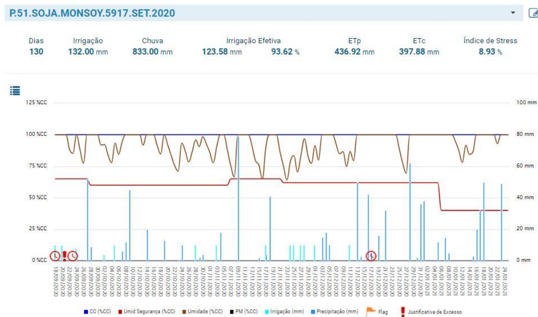
Figura 3. Evolução da umidade do solo estimada pelo software Irriger Connect na cultura da soja com os valores de irrigação e chuva, dentro dos limites de CC, f e PMP.
