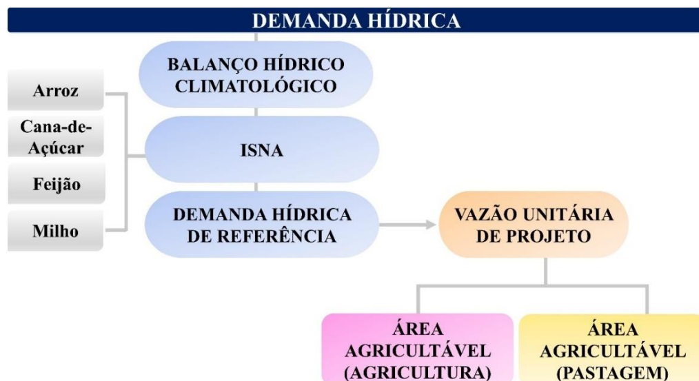
Figura 7. Síntese dos procedimentos para estimativa da demanda hídrica (ISNA: Índice de Satisfação à Necessidade de Água).
