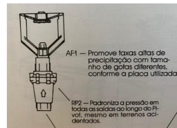
Figura 15. Detalhamento do regulador RP2 e emissor AF1 Fabrimar.
