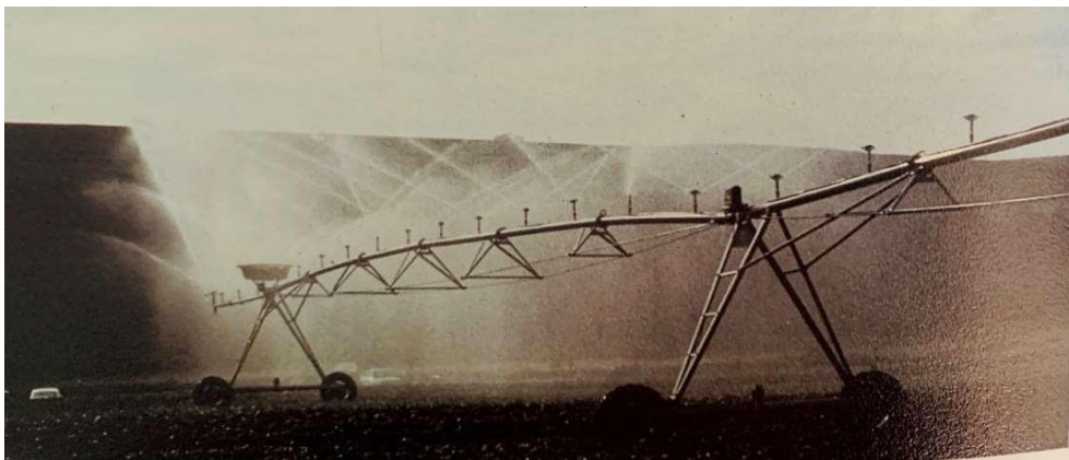
Figura 2. Pivô central Valmatic, com emissores de impacto ZE e ZED 30.
