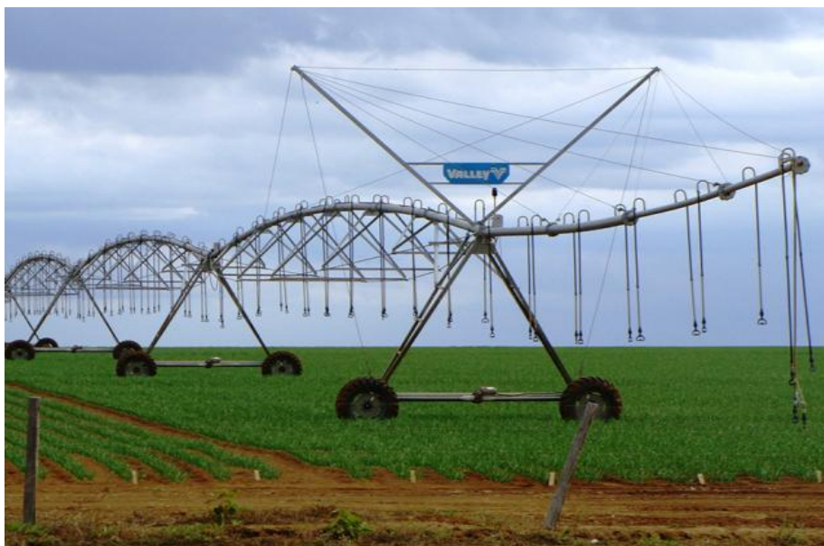
Figura 1. Vista lateral de um sistema de irrigação do tipo pivô central.
