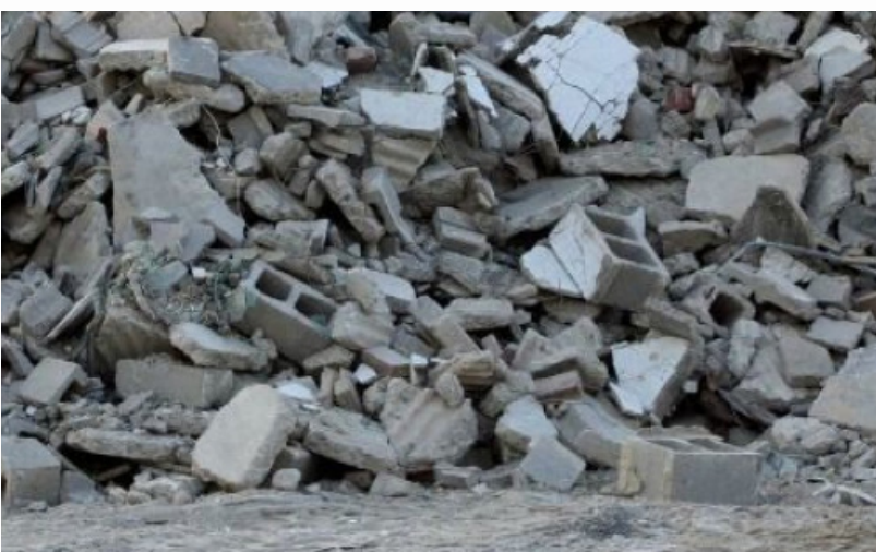
Figura 7 – Resíduo cinza (à esquerda) constituído por uma mistura de materiais cimentícios (concretos, argamassas, artefatos como blocos de concretos). Resíduo misto (à direita) composto por mistura de cerâmica vermelha e argamassa cimentícia.
