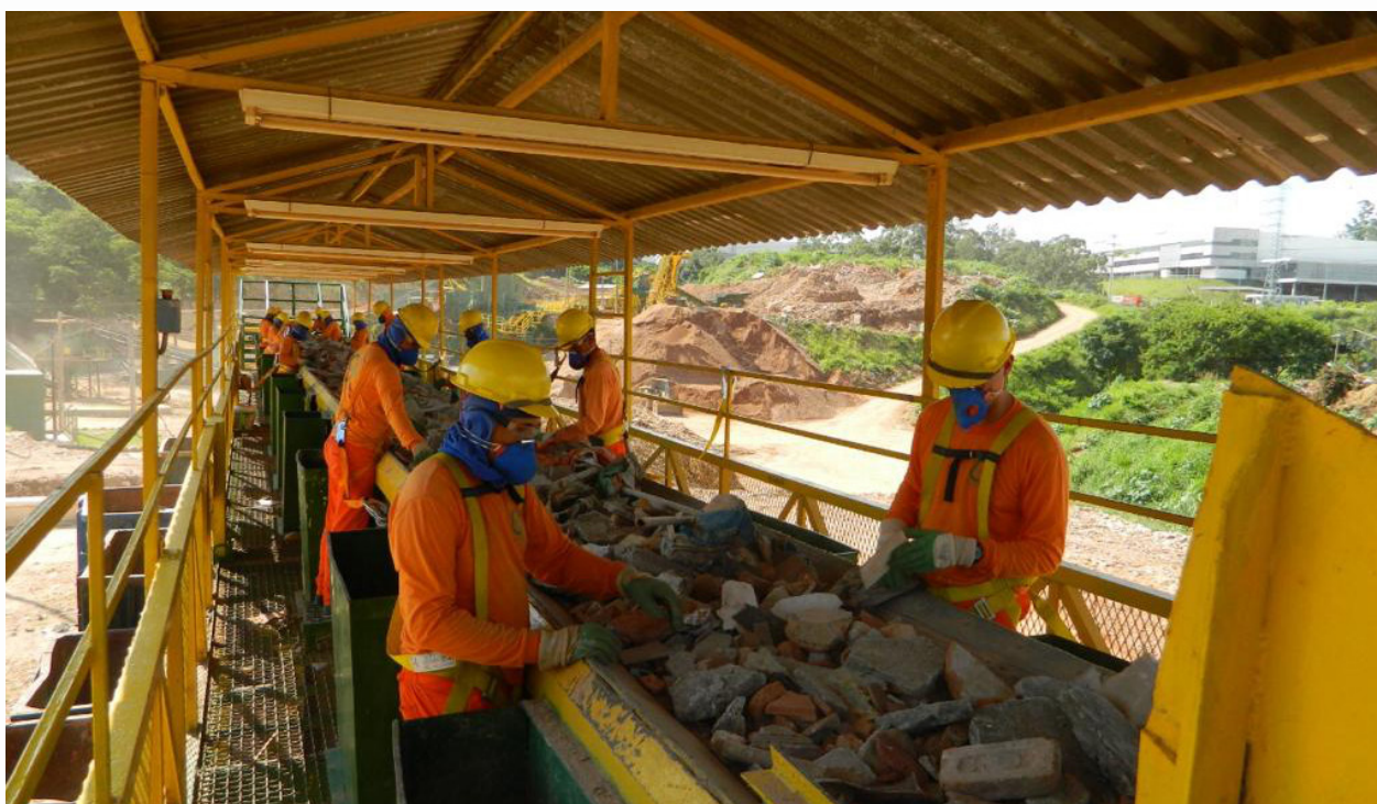
Figura 8 – Mesa de triagem removendo impurezas do RCD. São operadas em usinas de reciclagem, ou em algumas áreas de transbordo e triagem (produz agregado reciclado por simples peneiramento). Fonte: banco de imagens da ABRECON. Empresa SBR Reciclagem, Jundiaí/SP
