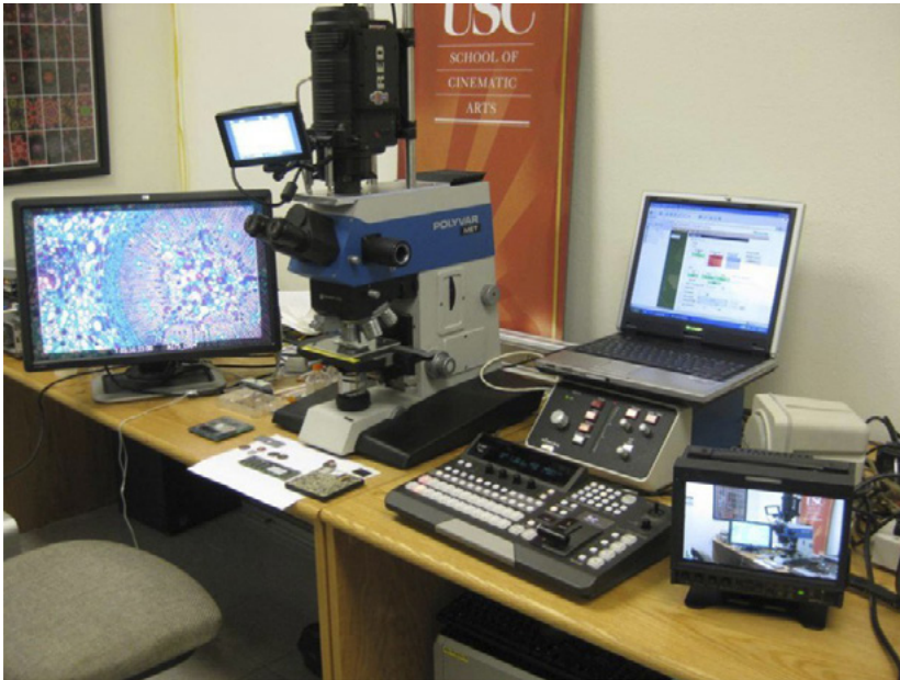
Figura 3 – Interface da câmera RED One para microscópio Reichert Jung Polyvar Met montada para transmissão remota (em cores na p. 233) .
