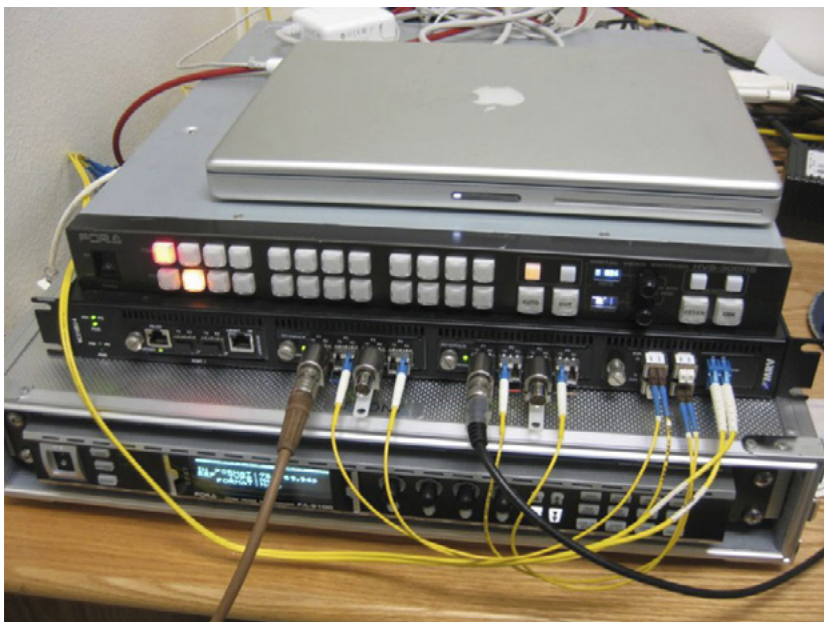
Figura 11 – Unidade de controle de vídeo FOR-A HVS-300HS, MRV HD-SDI para/de conversores ópticos, conversor de formato de multifunção FOR-A FA-9100.
