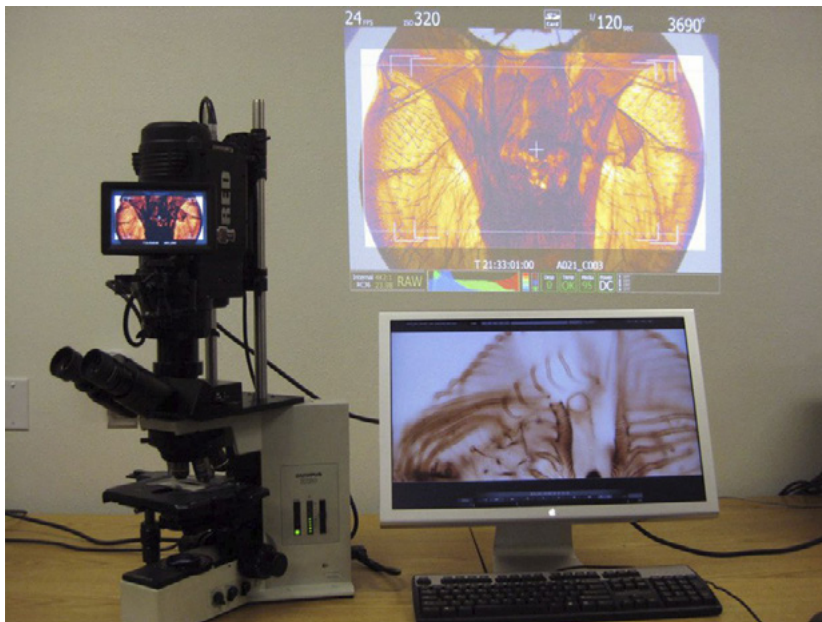
Figura 2 – Uma interface de câmera RED para microscópio Olympus BX50 (em cores na p. 233).
