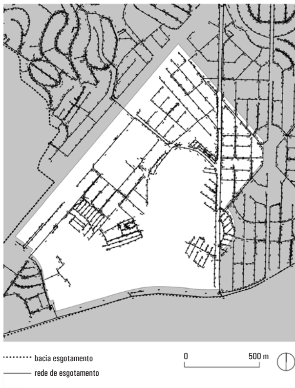
FIGURA 22 Parque Novo Mundo: área de estudo e cadastro rede de esgoto. Observar como a concentração de linhas coincide com os limites dos assentamentos informais e como a descontinuidade da rede nas áreas ocupadas pelas grandes glebas obriga o caminhamento das linhas em direção contrária ao ponto baixo do coletor tronco ao longo do Rio Tietê.
