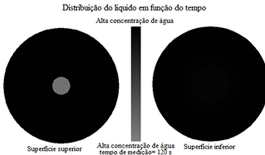
Figura 2 - Distribuição do líquido em função do tempo conforme software do aparelho MMT.
