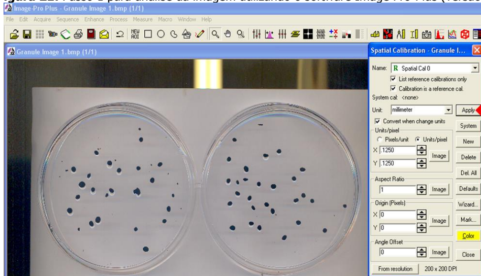
Figura 21: Passo 1 para análise da imagem utilizando o software Image Pro-Plus (versão 6.0).
