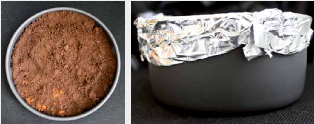
Figura 8: Forma metálica com terra vegetal e posteriormente coberta com papel alumínio para ser levada ao forno.
