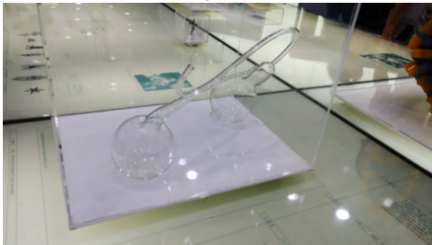
Figura 1 - Experimento de Louis Pasteur e o balão de vidro em formato de “pescoço de cisne”
