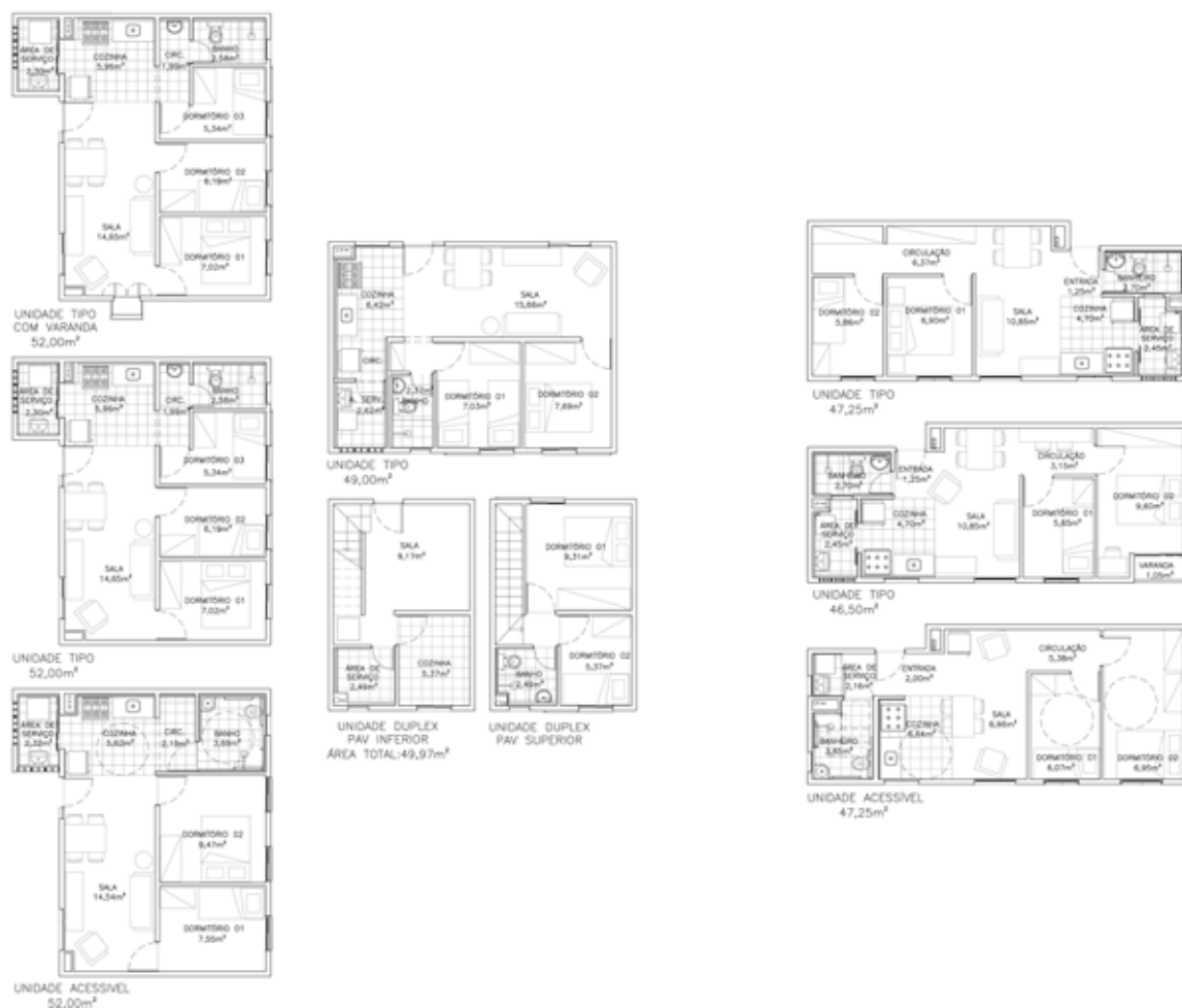
Fig. 132 – Conjunto de tipologias e pavimentos tipo no projeto do Sapé. Fonte: Acervo de pesquisa NAPPLAC.
