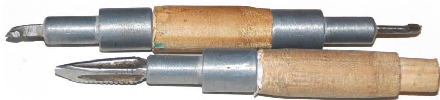
Figura 8 – Ferramentas elaboradas por Jerônimo para o corte da madeira. Foto: Andréia de Alcantara
