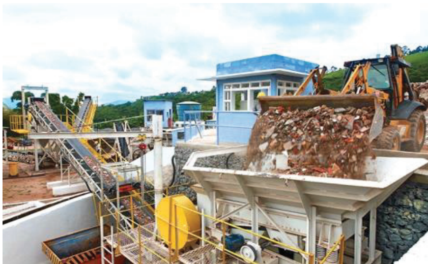
Figura 2 - Equipamentos constituintes de usina de reciclagem de RCC Fonte: Burim, 2012
