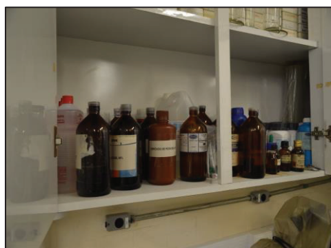
Figura 8 - Exemplo de armazenamento inadequado de produtos químicos
