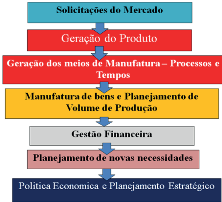
Figura 1.1 – Fluxo Geral de Informações de um sistema de manufatura Fonte: [7]
