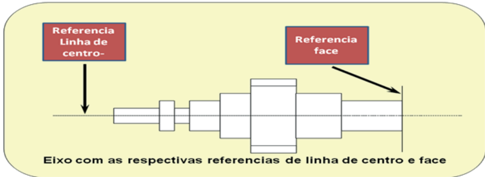
Figura 5.1 – Eixo com as respectivas referências de linha de centro e face Fonte: Elaborado pelo autor.
