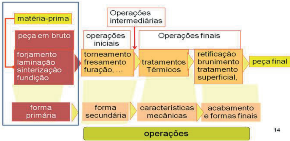
Figura 4.2 - Fluxo do processo de manufatura, com destaque para as peças em bruto
