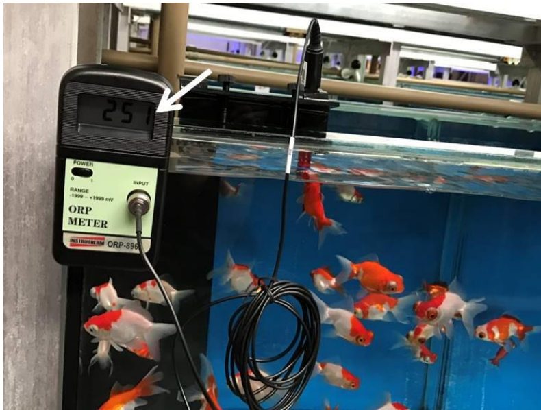
Figura 43: Aparelho para medir o potencial de óxido redução (ORP) da água e verificar o correto funcionamento o aparelho de ozônio.
