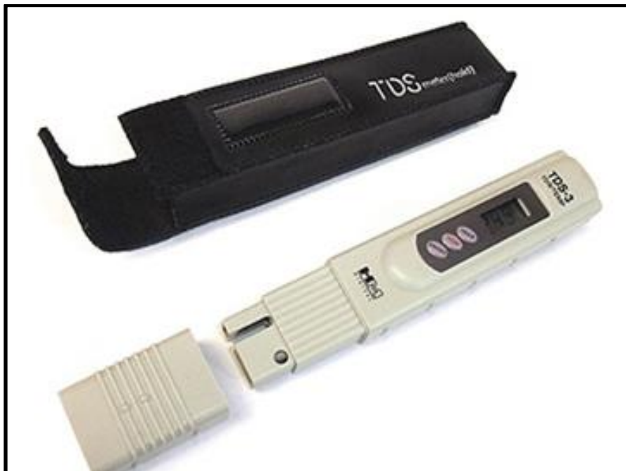
Figura 6 - Exemplo de equipamento para mensuração do total de sólidos dissolvidos (TDS) da marca HM Digital Water.
