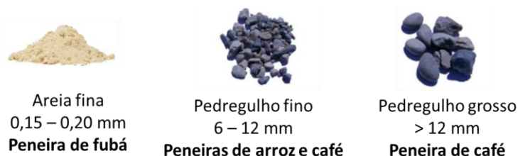
Figura 2 – Materiais filtrantes e seus respectivos tamanhos de grãos após o peneiramento
