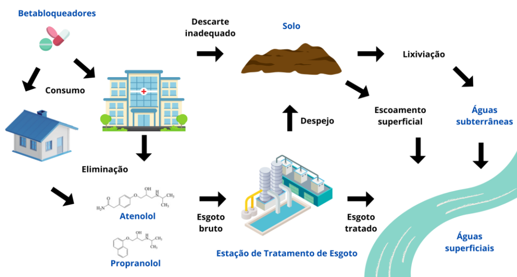
Figura 1 – Modelo conceitual simplificado das fontes e transporte dos betabloqueadores atenolol e propranolol no ambiente
