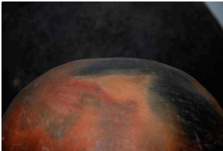
Figura 96: Tonalidades da superfície de uma peça em queima oxidante-reutora. Coleção BBM, 2010. Foto: Jean- -Jacques Vidal.
