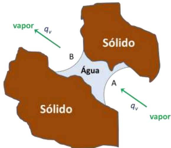
Figura 7.7 - Passagem de vapor de água através de uma barreira de água líquida num poro do solo. Conforme ocorre condensação de água no menisco do lado A ocorre evaporação do lado B.
