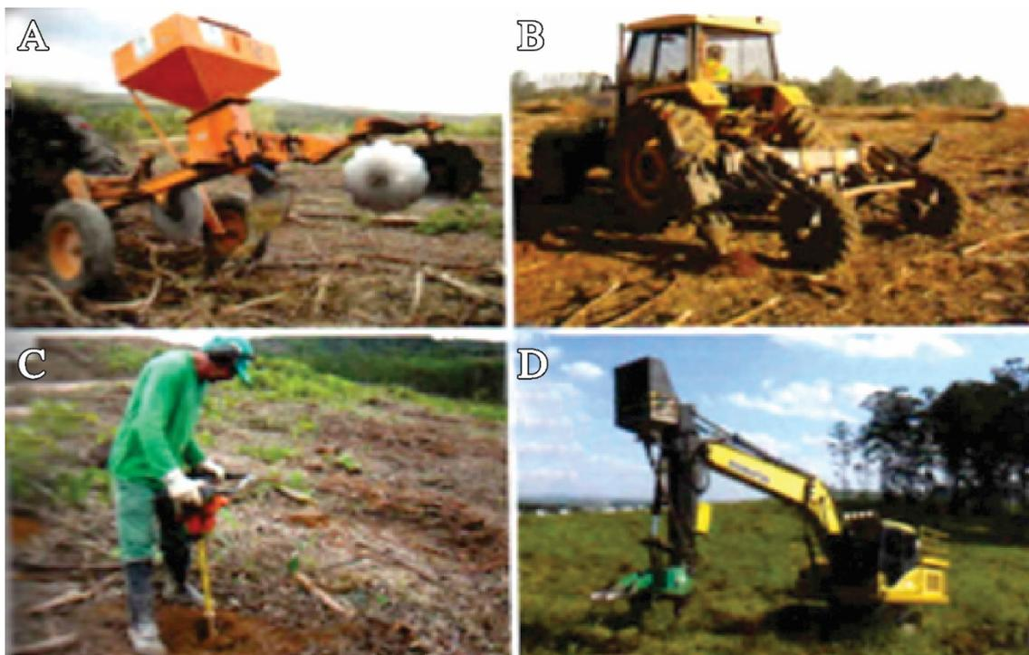
**Figura 15** - Equipamentos utilizados no sistema de preparo reduzido ou Plantio Direto em eucalipto. Item (A) subsolador florestal; item (B) cavadeira dupla; item (C) moto cavadeira; item (D) cavadeira Rotroe. **Fonte:** Gonçalves J.L.G. et al. (2019).
