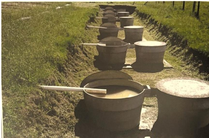
**Figura 6** - Calhas coletoras, com o divisor de enxurrada tipo “Gibb” entre as caixas. **Fonte:** Bertol I.
