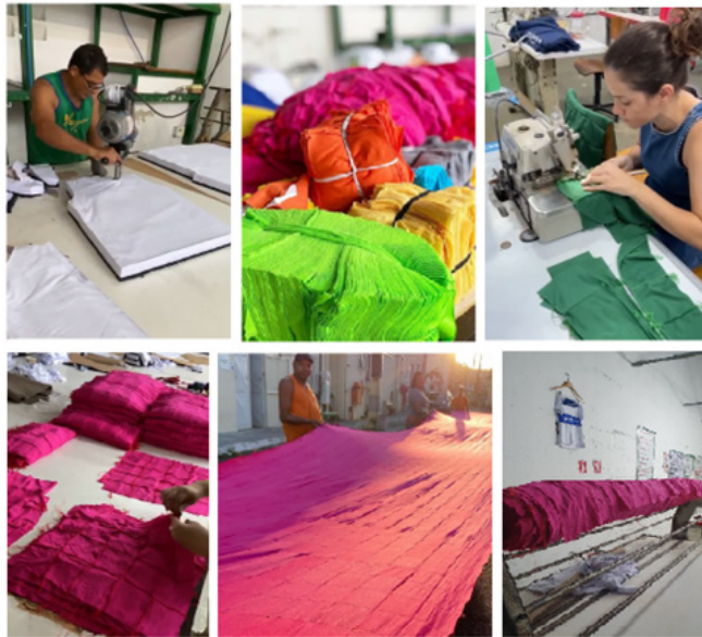
Figura 7 – Etapas de produção desde o corte até a montagem do rolo de tecido.
