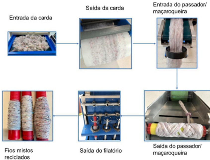
Figura 8: Principais etapas do processo de fabricação dos fios reciclados
