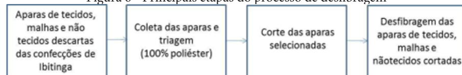
Figura 6 - Principais etapas do processo de desfibragem
