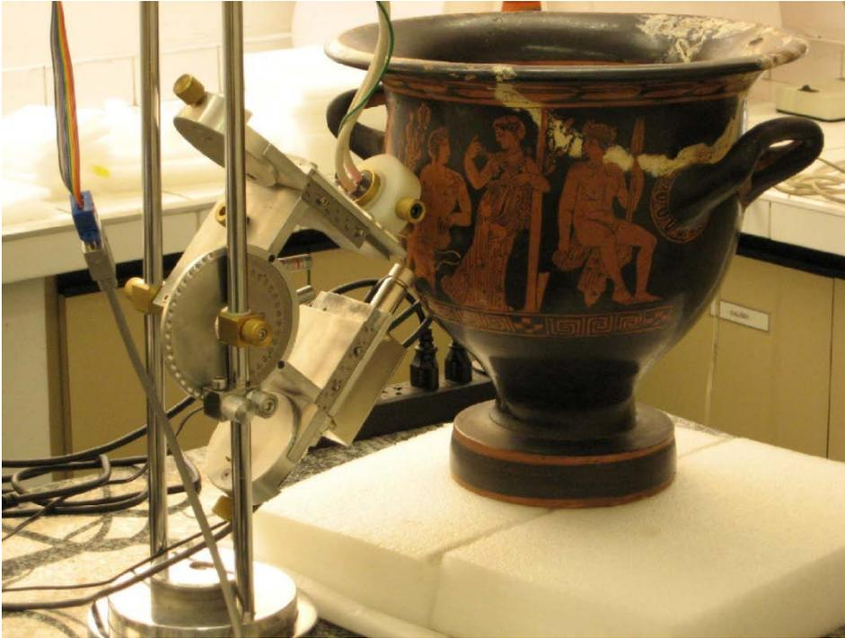
Figura 3: Aparelho de fluorescência de raios X portátil posicionado para uma medição.
