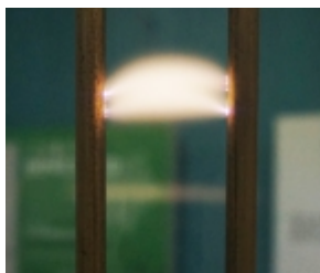
Figura 8 – Plasma: quando o visitante aperta o botão do experimento, uma faísca surgirá entre as duas hastes do experimento. Este fenômeno tem o mesmo princípio físico da formação de relâmpagos
