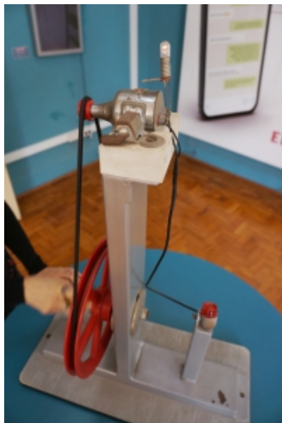
Figura 5 – Gerador elétrico: um dínamo é acionado por meio de uma manivela, transformando a energia mecânica em energia elétrica. O brilho da luz varia de acordo com a velocidade de rotação da manivela
