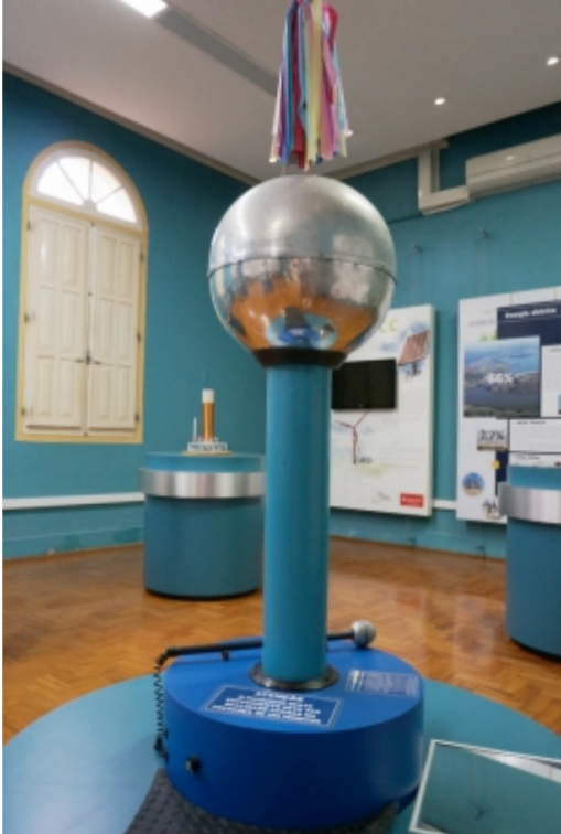
Figura 7 – Gerador de Van de Graaff: experimento que chama a atenção dos visitantes, pois possibilita sentir no corpo, de forma segura, os efeitos da eletricidade estática
