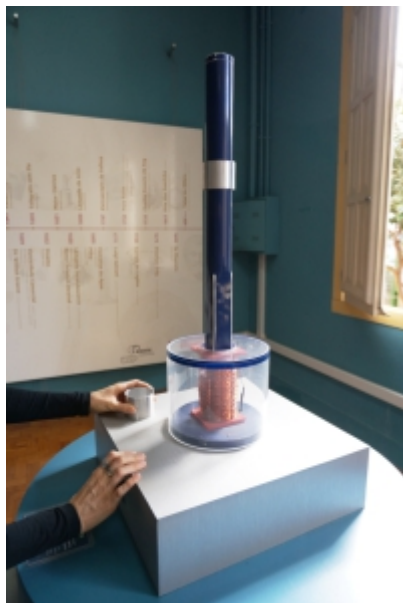
Figura 9 – Anel saltitante: o anel inteiro sofre repulsão pelo campo magnético variável da bobina
