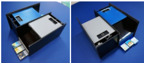
Figura 15 - Compartimentos com enfoque nas fichas magnéticas cinzas (montagem à esquerda) e azuis (montagem à direita) e no encaixe correto das mesmas nas fendas traseiras, que ativam a iluminação
