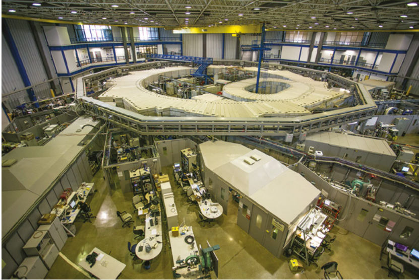
Figura 3.5. Laboratório Nacional de Luz Síncrotron (LNLS). As linhas de luz são tangentes ao anel de armazenamento dos elétrons relativísticos, que perdem energia emitindo radiação eletromagnética. Fonte: Divulgação LNLS/CNPEM
