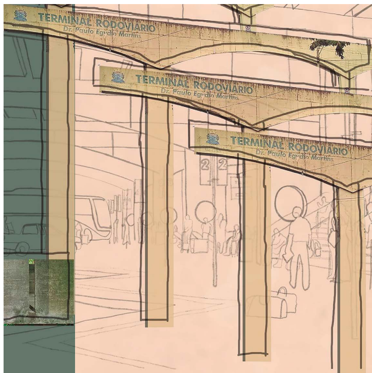
Figura 16 – imagem do inventário do grupo 1. A imagem, concebida a partir de uma colagem, representa o edifício que abriga a rodoviária, de arquitetura moderna, com o sistema estrutural de pilares e vigas em concreto armado aparente que define a volumetria do edifício
