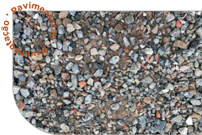
Figura 23- Brita graduada reciclada cimentícia (granulometria, com dimensão inferior a 25 mm) e execução de camada de base. Fonte: google imagens.
