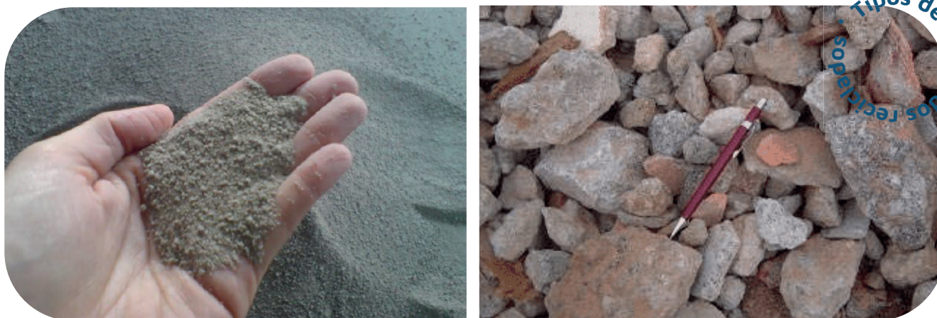
Figura 5 - (à esquerda) Areia reciclada cimentícia (ARCI), obtida pela britagem de resíduos de argamassa e blocos de concreto em obras. Fonte: S. C. Angulo; (à direita) brita reciclada cimentícia (piso, alvenaria de concreto), incluindo uma pequena fração de cerâmica vermelha. Fonte: google imagens.
