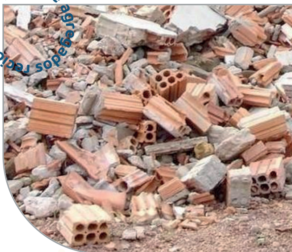
Figura 2- RCD misto: demolição de alvenaria de blocos de cerâmica vermelha, misturado com solo de escavação e diversas impurezas (tubulações de instalações elétricas, de água, madeira, metais). Fonte: google imagens.
