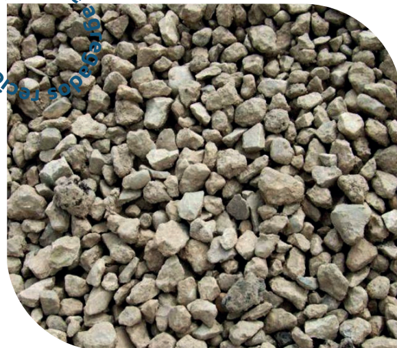
Figura 7 - Brita reciclada de concreto (ARCO graúdo). Pode conter, em pequena quantidade, alguns materiais secundários (como cerâmica vermelha, ou impurezas). A partícula contém cimento endurecido e agregados naturais (areia de rio) e artificiais (rochas britadas). Fonte: google imagens.
