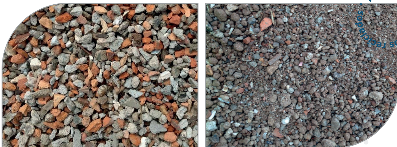
Figura 3 – Brita reciclada mista (ARM graúdo) (à esquerda). Contém partículas cimentícias e de cerâmica vermelha (em maior quantidade), de 10 a 40%, usualmente. Pode conter impurezas, quando o resíduo não é bem triado na origem. (à direita) Bica corrida (ARM) (dimensão inferior a 50 mm). Fonte: google imagens.
