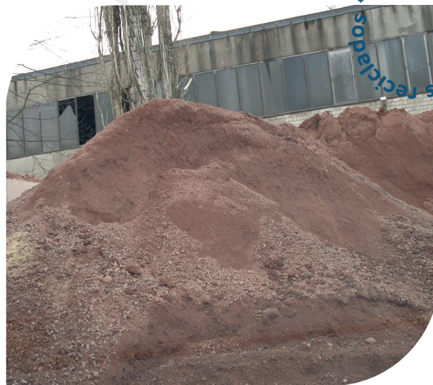
Figura 8 – Solos (finos naturais) obtidos por escalpe, antes da britagem do RCD. É comercializado como um produto secundário das usinas de reciclagem, mas que, dependendo do RCD recebido na usina, pode chegar a representar quase metade da massa de entrada das usinas.
