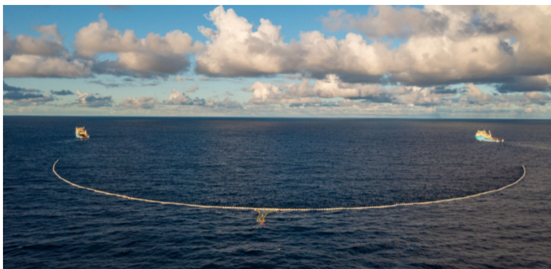
Fig. 4.19 - Sistema 002 do Ocean Clean Up sendo testado para captura de plástico na Grande Ilha de Lixo do Pacífico. (Foto: theoceancleanup.com )
