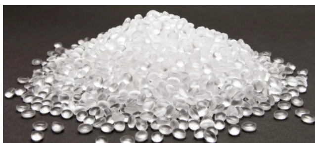
Fig. 3.7 - Pellets transparentes utilizados como matéria-prima para a produção de plástico. (Fonte: https://www.erplasti.com.br/single-post/mercado-instabilidade-na-mat%C3%A9ria-prima )
