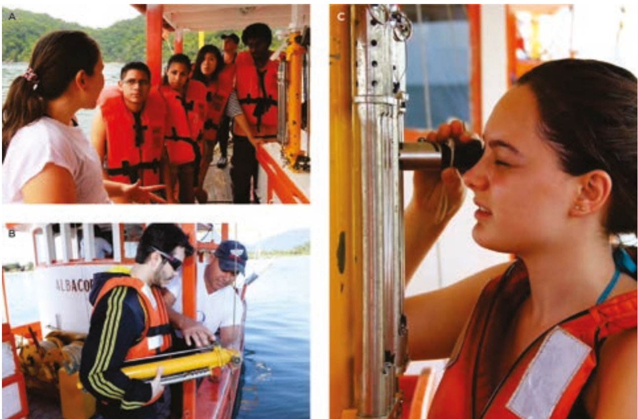
FIGURA 2. Atividades realizadas durante a simulação de estação oceanográfica: A) Instruções sobre a operação dos equipamentos; B) Lançamento da Garrafa de Nansen para coleta de água ; e C) Observação dos termômetros de reversão para obtenção da temperatura. Fotos: Luciano Pereira de Souza.
