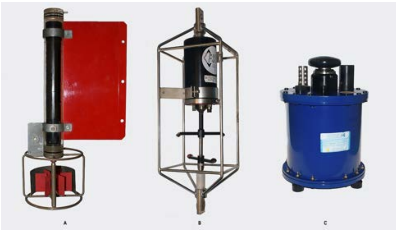
FIGURA 12. Três modelos de correntômetros: A) mecânico; B) acústico; e C) eletromagnético.
