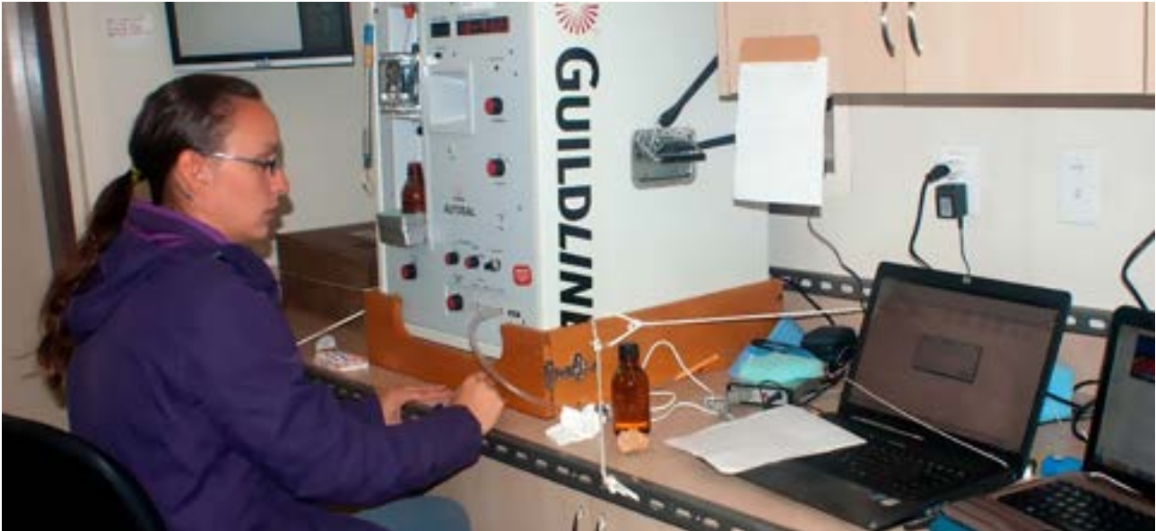
FIGURA 17. Exemplo de fixação de equipamentos em uma bancada no navio, com o uso de cabos sintéticos e extensores elásticos. Foto: Luiz Vianna Nonnato.
