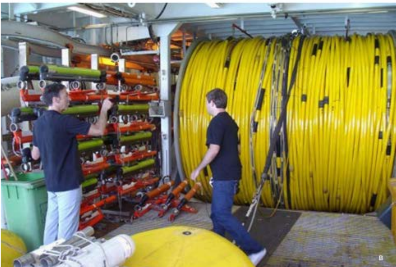
FIGURA 5. O sistema de aquisição sísmico é formado essencialmente por uma fonte emissora de ondas sísmicas, exemplificado em (A) por um sparkler , e por um conjunto de receptores, conhecidos por hidrofones, que ficam instalados em longas “mangueiras” (B), conhecidas como streamers .
