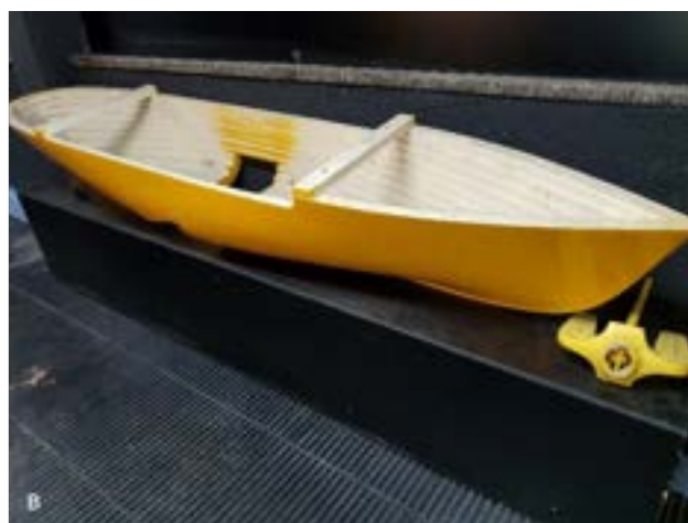
FIGURA 9. O desenvolvimento da tecnologia: o Batiusp (A); e o modelo de casco do navio Besnard, feito para os testes hidrodinâmicos antes de sua construção (B). Foto: Elisabete S. Braga.
