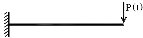
a) Viga em balanço
